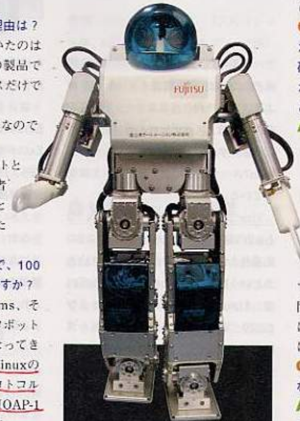
身長48cm、体重6kgとHOAP-1は小型・軽量に設計されている。20個の特注モーターを搭載
