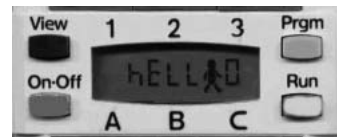
図 3 LCD, 四つのボタン, ポートラベル。
