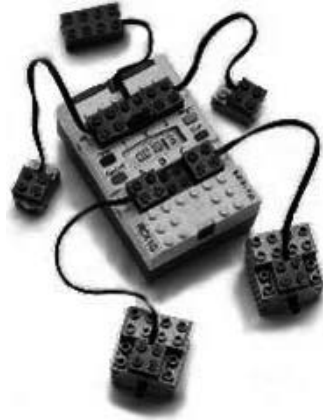
図 2 RCX(出力ポート A と C にモータを、センサポート 1 番と 3 番にタッチセンサを、2 番に光センサを接続している)。
